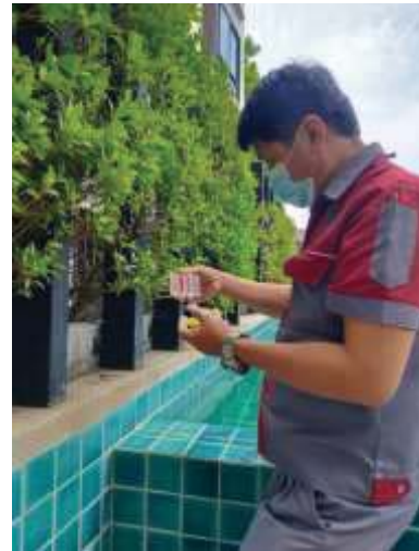
ภาพที่ 3.5.4-2 การตรวจวัด pH และ \text{Cl}_2 สระว่ายน้ำ
